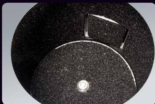
Nerezový odlučovač škrabu a zbytků slupek. Korundový vnitřek bubny škrabky.
